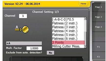
4. Geben Sie die Parameter : dia Rods, dia Max, dia Min und preset. Dann klicken Sie die «Kalibrierung» Taste
