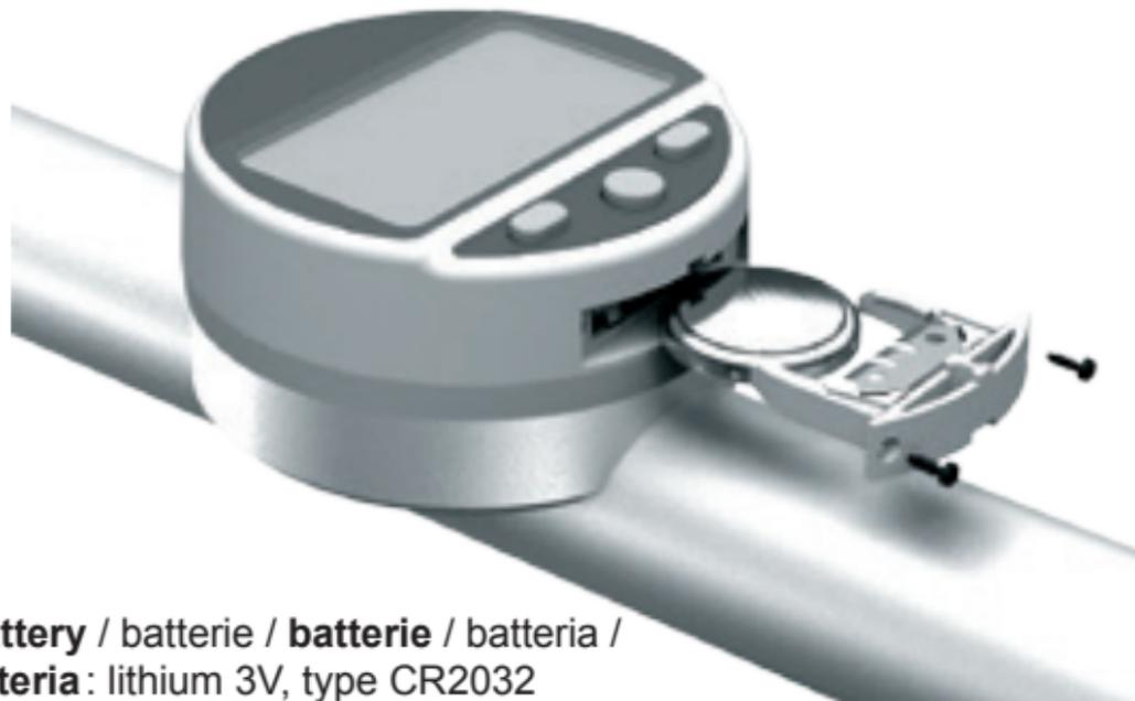
**Battery / batterie / batterie / batteria /
