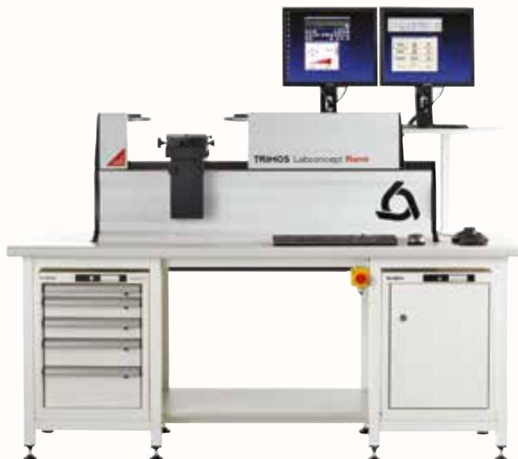
*Misura in CNC anche diametri interni filettati*
